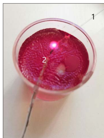
Рис. 3. Внешний вид контейнера с фантомом: в фантом введено световолокно (1), через торец которого наблюдается пилотное лазерное свечение; рядом с торцом установлен термосенсор (2).
