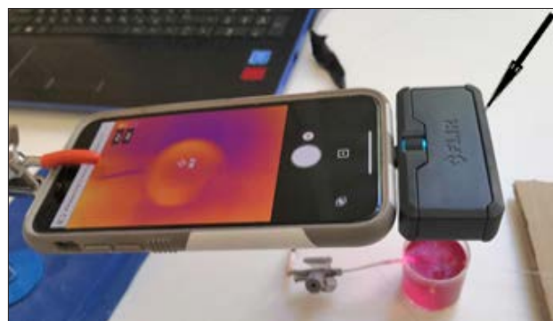
Рис. 4. Внешний вид тепловизора FLIRONE PRO for IOS. Стрелка указывает на тепловизор, расположенный как приставка к смартфону над фантомом.
