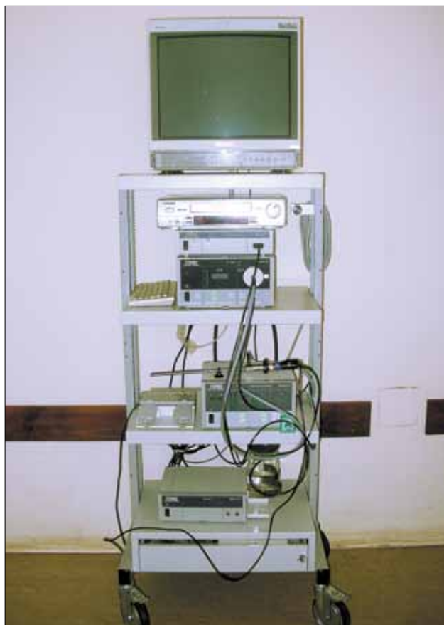
Рис. 3. Видеоэндоскопическая аппаратура с возможностью проведения флюоресцентной гистероскопии, производства Karl Storz GmbH, Германия
