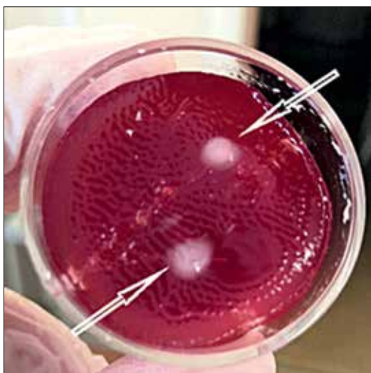
Рис. 5. Фантом. Стрелками показаны зоны помутнения в результате лазерного облучения.
