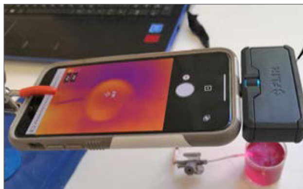
Рис. 4. Внешний вид тепловизора FLIRONE PRO for IOS. Стрелка указывает на тепловизор, расположенный как приставка к смартфону над фантомом.
