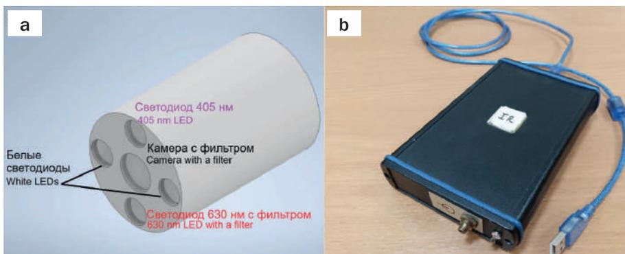
**Рис. 1.** Диагностическое оборудование: а – стробоскопический флуоресцентный имиджер (СФИ); б – спектрометр ЛЕСА-01 БИОСПЕК.
